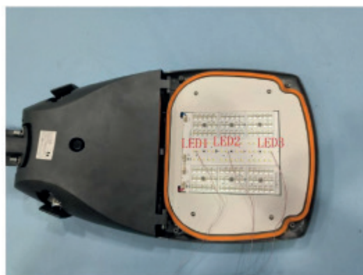
Ensayo bajo TM-21 para el chip de LED dentro de la luminaria y realizado a temperatura ambiente de 40°C.
